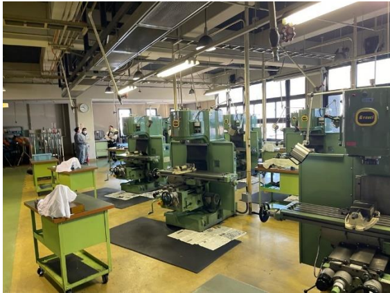
フライス盤各機の後ろの柱（移設不可） 窓から離れた位置の機器の上に蛍光灯
