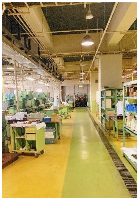
柱に沿ってグレーチングあり 左上には暖房設備が一系列あり
